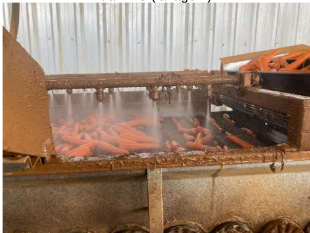
Figura 05: Processo de beneficiamento de hortifruti da BAC (lavagem).
