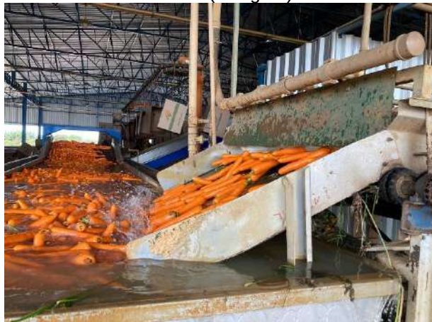
Figura 06: Processo de beneficiamento de hortifruti da BAC (lavagem).
